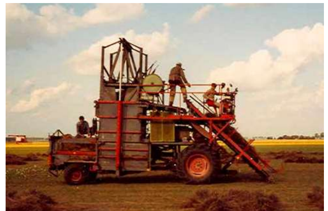
Vlaspers, brede versie, tweede variant, vanaf 1976. De eerste variant (1975) had een korte opvoerband. De tweede variant is gebruikt tot eind jaren tachtig
