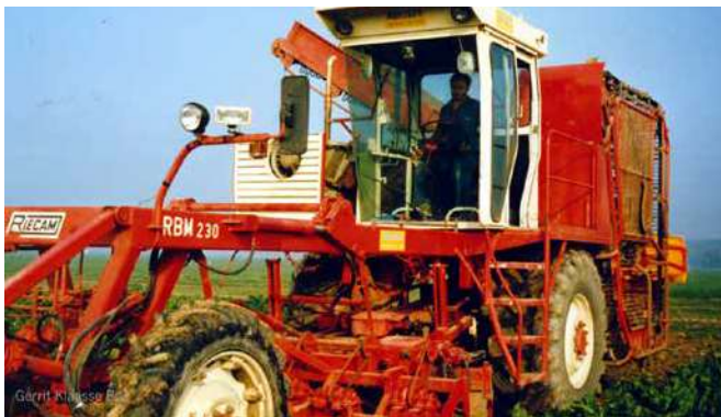
De door mechanisatiebedrijf Riemens en Andre Cammaert ontworpen en later door Karlie van de Vijver doorontwikkelde Riecam bietenrooier. Op de foto uit 1986 een nog verder doorontwikkelde versie
