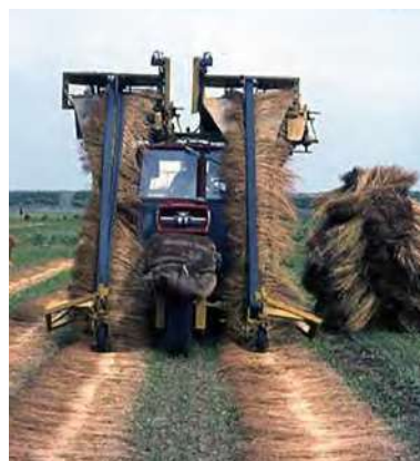
De vlasspers voor groen vlas, ontworpen door Van de Bilt. Gebouwd door mechanisatiebedrijf Riemens met Karlie van de Vijver (omstreeks 1975)
