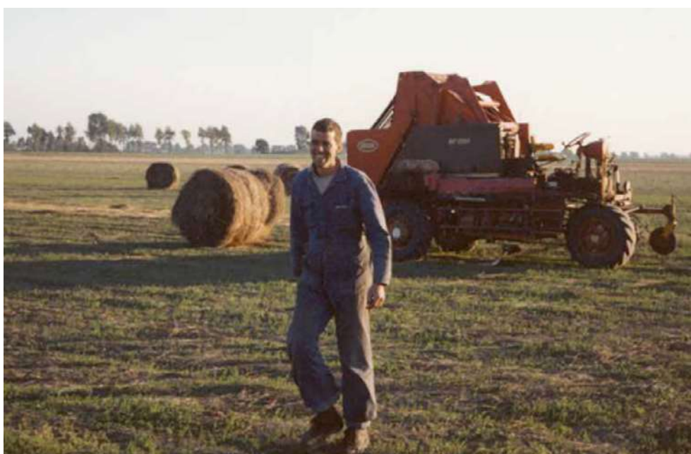
De zelfrijdende rolpers (1990). De opbouw was een Vicon rollenpers. De onderbouw hadden Huub en Marc Buijsse zelfgemaakt, in samenwerking met het bedrijf van Karlie van de Vijver
