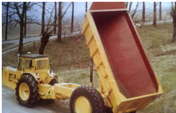
Voorbeeld van een machine ontwikkeld door Karlie van de Vijver bij mechanisatiebedrijf Riemens: een gronddumper. Voorloper van de Volvo gronddumpers (omstreeks 1980)
